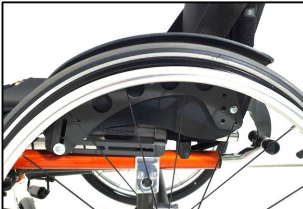
Die Rollstühle sind mit ultraleichten Hinterrädern mit Steckachsen ausgestattet. Dieses System ermöglicht es, die großen Räder auf äußerst einfache Weise zu entfernen, und den Rollstuhl mit weniger Volumen und Gewicht transportieren zu können.
