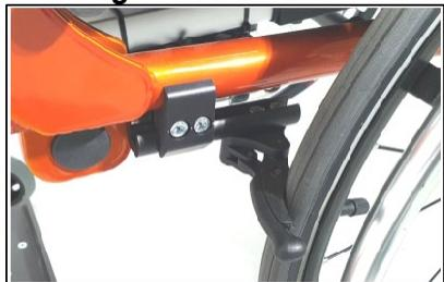
**ACHTUNG:** Wenn die Bremsen betätigt werden, muss der Teil, der das Rad blockiert, den Reifen richtig zusammendrücken, um ein Drehen zu verhindern!!
