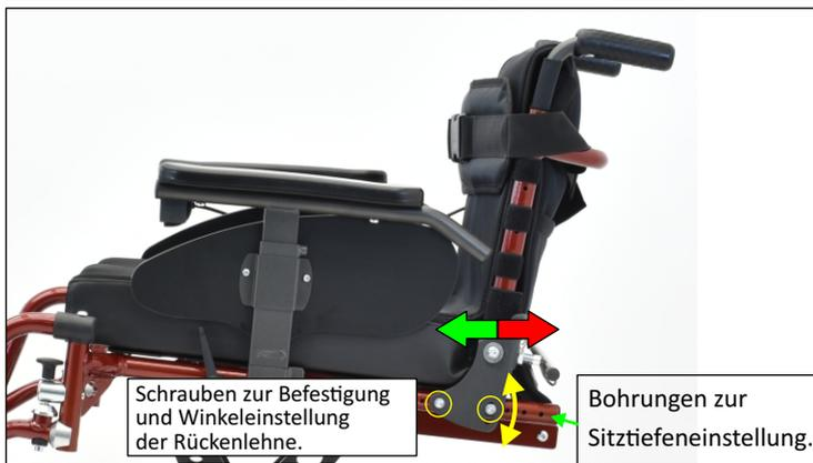
Die Rückenlehne des Rollstuhls 17.57HV kann in der Neigung angepasst werden. Über die Rückenlehne lässt sich auch die Sitztiefe verstellen.
