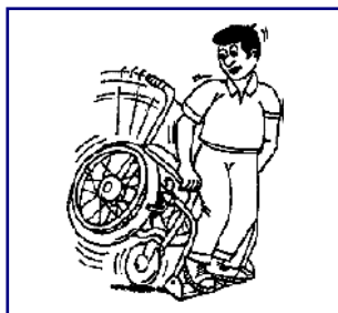
STELLEN SIE SICH NIE AUF DIE FUßPLATTEN! ES BESTEH STURZGEFAHR!
